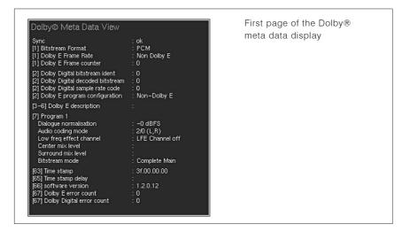
Fig. 5-50: The Dolby® Meta Data display (DOLBY® META DATA)
