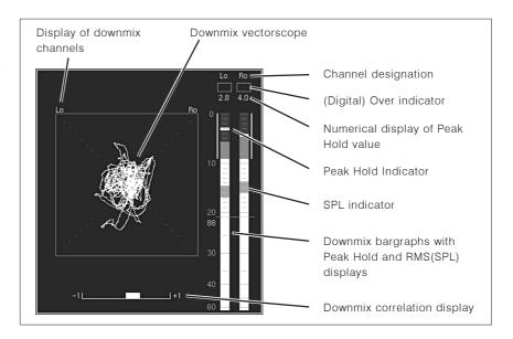
Fig. 5-28: The 2-Channel Downmix Meter instrument (DOWNMIX)
