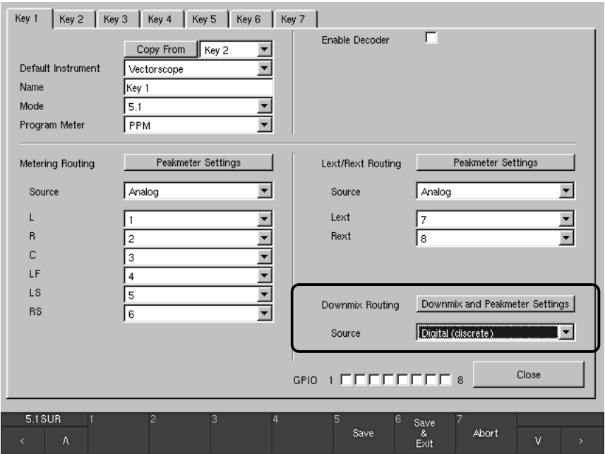
Fig. 6-32: The Downmix Routing section (Markierung)
