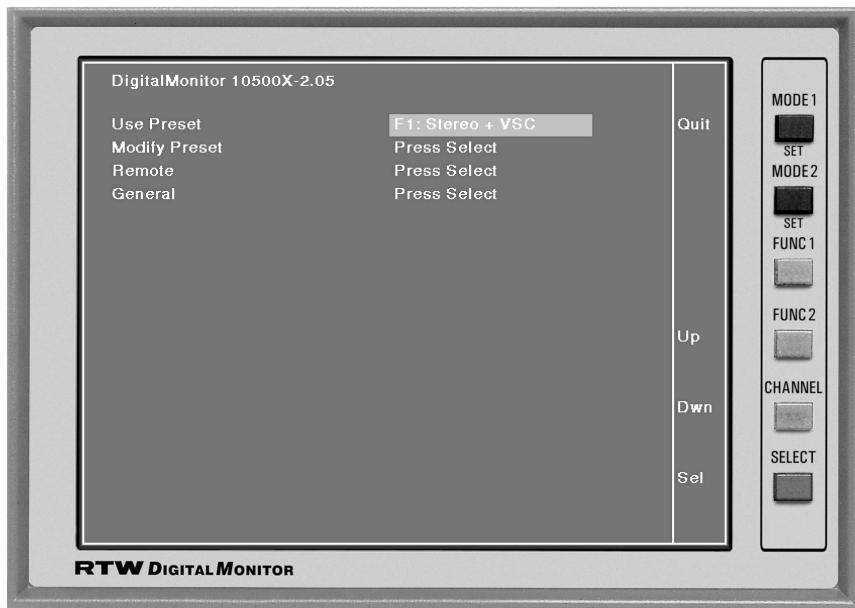
Bild D 3-2: Das Hauptmenü des DigitalMonitor 10500X-PLUS
