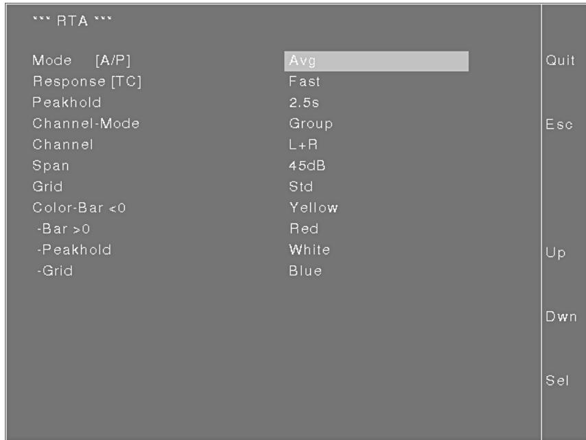
Bild D 4-15: Menü „RTA“ mit RTA-Parametern
