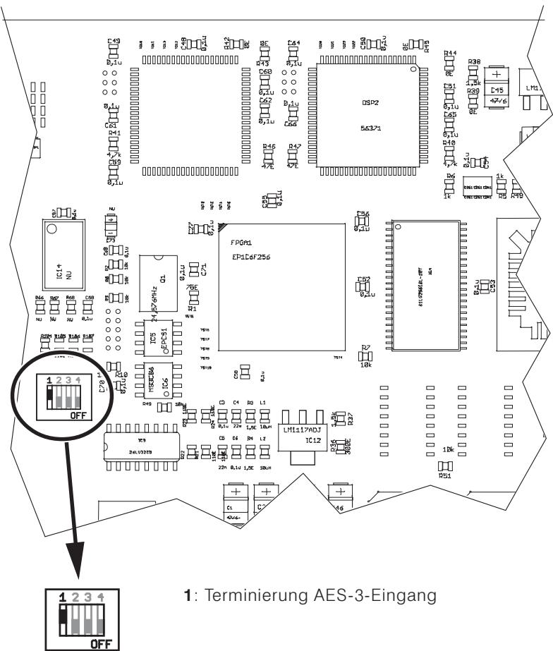
Bild D 6-2: Teilansicht der Hauptplatine mit DIP-Schalter
