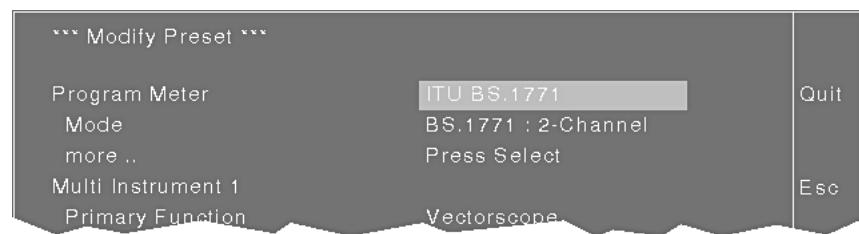
Bild D 5-7: Der angezeigte Modus im Menü „Modify Preset“, wenn der ITU BS.1771-Modus gewählt ist
