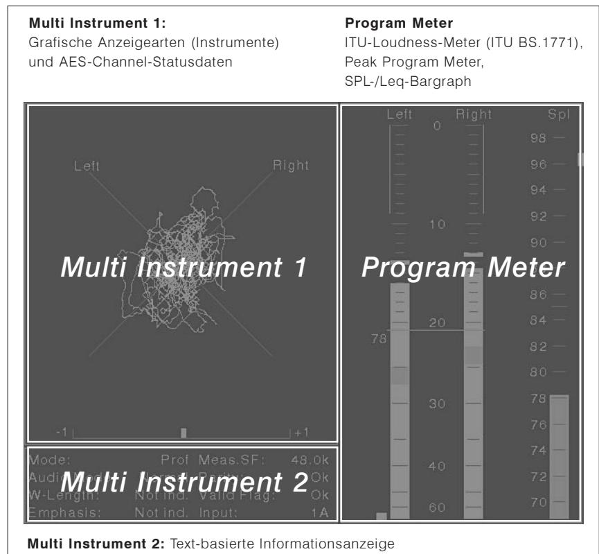
Bild D 2-1: Die Displayelemente des DigitalMonitor 10500X-PLUS
