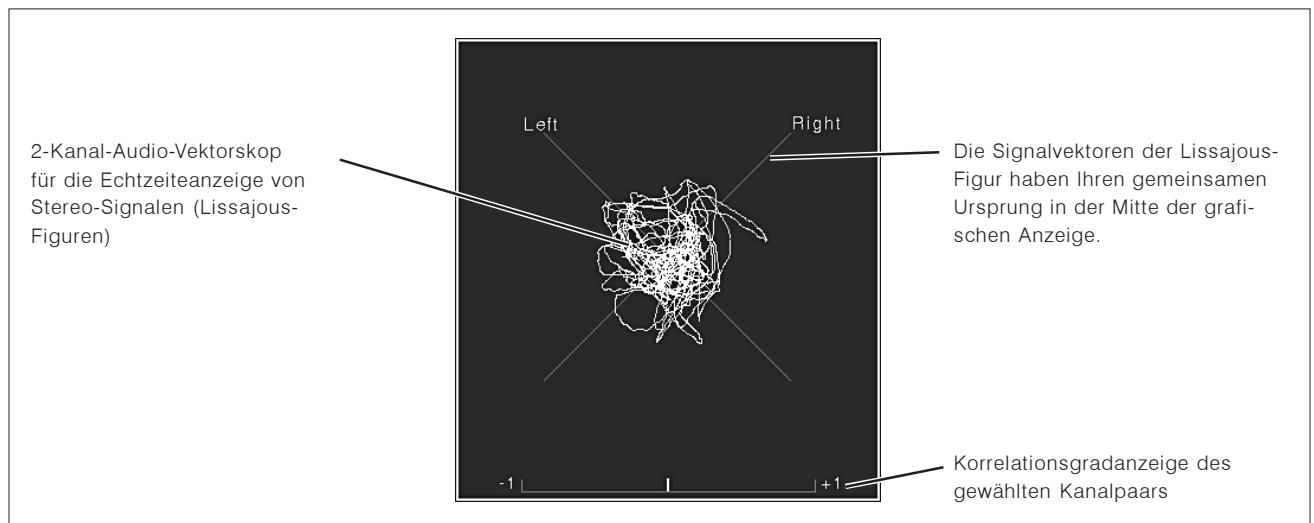
Bild D 4-12: Das 2-Kanal-Audio-Vektorskop im „Multi Instrument 1“
