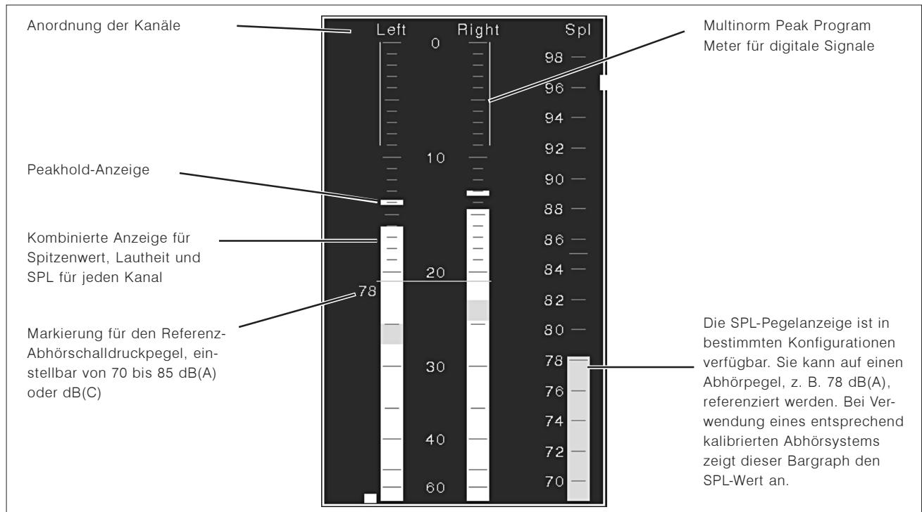
Bild D 4-1: Die „Program Meter“-Anzeige im PPM-Modus
