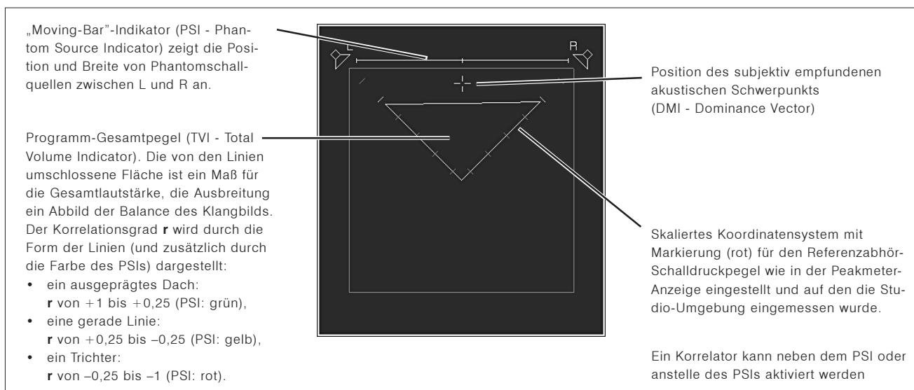
Bild D 4-7: Der Stereo-Sound-Analyzer im „Multi Instrument 1“
