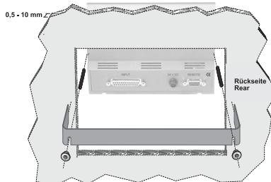
Einbaukit **13713** für den Frontplatteneinbau
