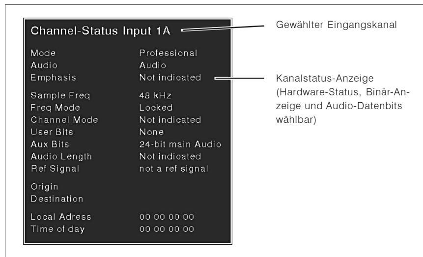
Bild D 4-18: Die Channel-Statusanzeige (Kanalstatus) im „Multi Instrument 1“
