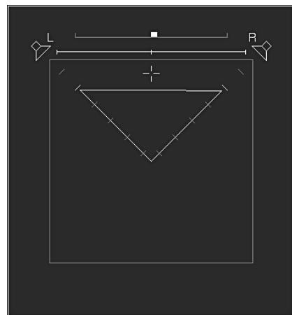
Bild D 4-9: Der Stereo-Sound-Analyzer mit PSI- und Korrelatordarstellung
